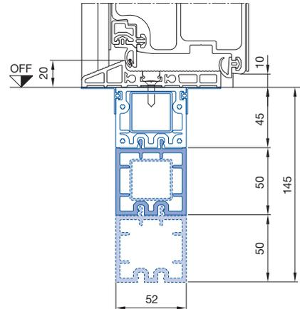
Bodeneinstand mit Bodenaufbauprofil BP-K 50 (lose) (hier aufgedoppelt dargestellt)
