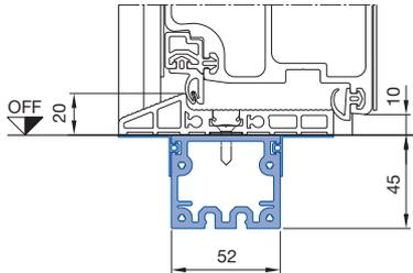
Bodeneinstand/Transportschutz Standard in Elementbreite mit Profilschlussdichtung PAD außen und innen (lose) (im Türpreis enthalten)
