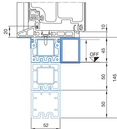
Ausgleichsprofil Neubau AP-N 100 Innen mit Vierkantrohr (lose)  $45 \times 34 \times 3$  (für Versatz innen) und Profilschlussdichtung PAD (hier dargestellt mit aufgedoppeltem BP-K 50)
