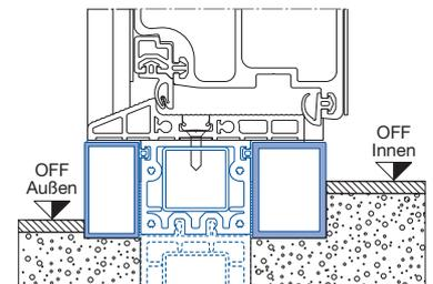
optimal für Türmontage bei Höhenversatz zwischen Außen- und Innenfußboden (hier dargestellt mit AP-N 100 außen und innen)
