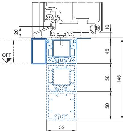
Ausgleichsprofil Neubau AP-N 100 außen mit Vierkantrohr (lose)  $45 \times 25 \times 2$  (für Versatz außen) und Profilschlussdichtung PAD (hier dargestellt mit aufgedoppeltem BP-K 50)
