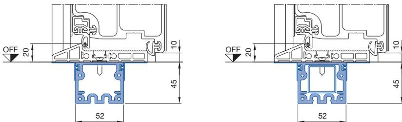
Bodeneinstand/Transportschutz Standard in Elementbreite mit Profilschlussdichtung PAD außen und innen (lose) (im Türpreis enthalten)
